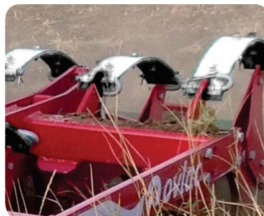
Sécurité Non Stop à lame de ressort à pression dégressive et 100% sans entretien
