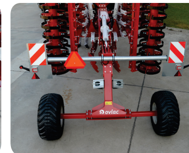
Essieu large avec suspension pour le transport routier. Homologation européenne
