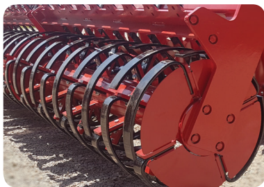
Rouleau à lames 520 mm (130kg/m)
