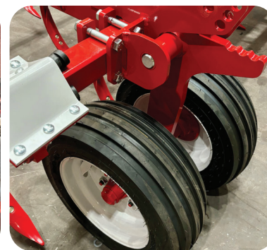
Roues avant jumelées 200/60 14.5" repliables hydrauliquement pour le transport (de série).
