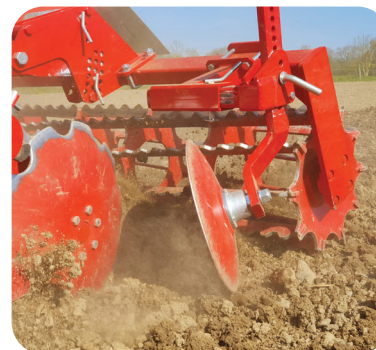
Disque de bord gauche pour fermer le sillon formé par le disque arrière gauche.
