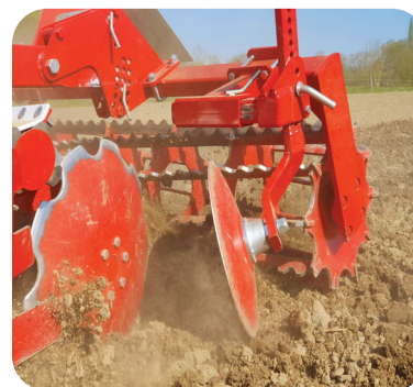
Disque de bord gauche pour fermer le sillon formé par le disque arrière gauche (option).
