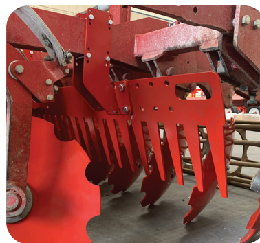
Peignes placés entre les rangées de disques ou entre les disques et le rouleau pour freiner le flux de terre et l'émietter (option).
