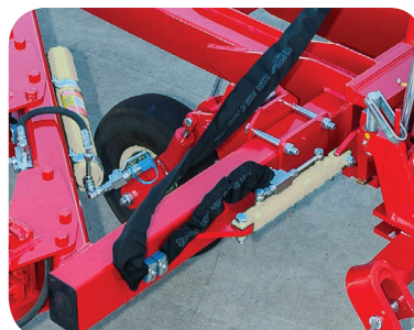
Déport hydraulique du 1er corps
