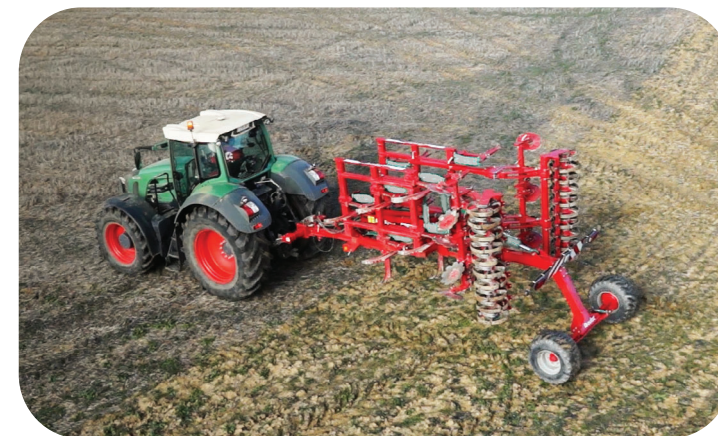
Après seulement un passage, le sol est parfaitement nivelé et les pailles diluées dans la terre.
