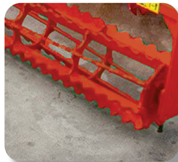
Rouleau à platines crantées de 400 mm ou 520 mm.
