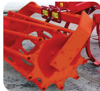
Rouleau à barres de 480 mm ou 540 mm.
