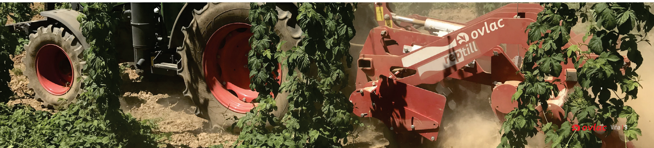
Châssis relevable hydrauliquement pour une meilleure maniabilité en bout de champ.
