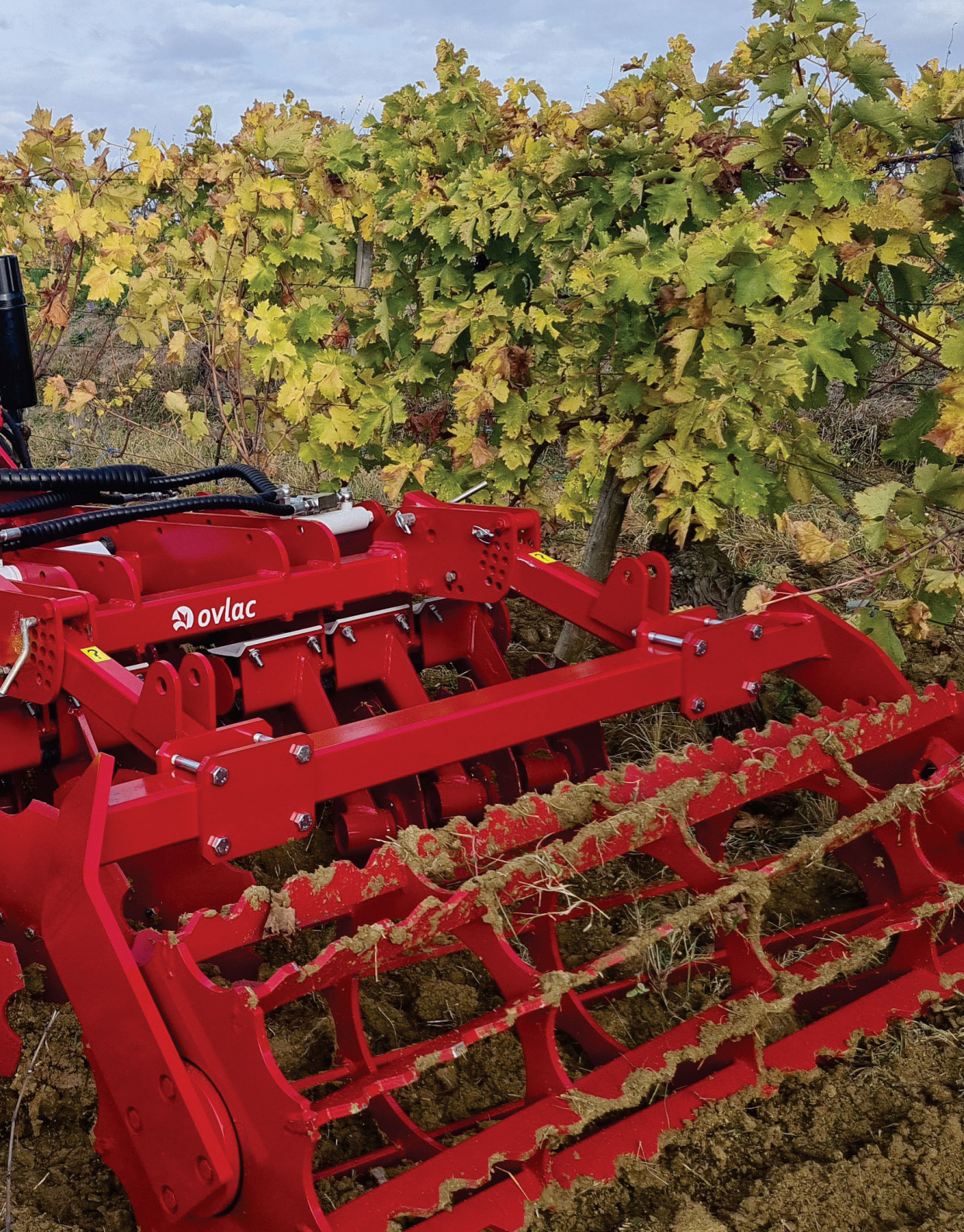
Disques de 20" (510 mm) en 6 mm d'épaisseur.
