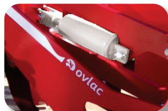
Réglage hydraulique de la profondeur du décompacteur.
