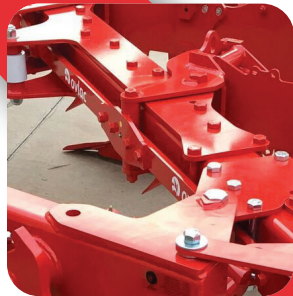
Poutre renforcée avec plaques THLE.
