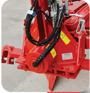
Fusée creuse pour un passage optimisé des flexibles.
