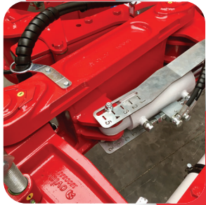
Parallélogramme permettant de changer les réglages au travail.
